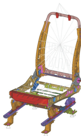
图 1 驾驶员座椅有限元模型
