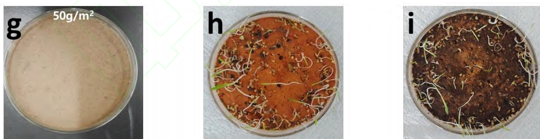
(g) 50g/m 喷洒定量抑尘剂的成膜性 (h) 喷洒清水 5 d 后种子生长状态 (i) 喷洒抑尘剂 5 d 后种子生长状态
