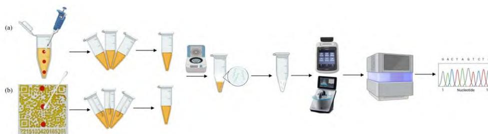
图 1 验证标签中 DNA 溯源码分布均匀性示意图 (a) 试管中均匀性 (b) 二维码标签中均匀性
