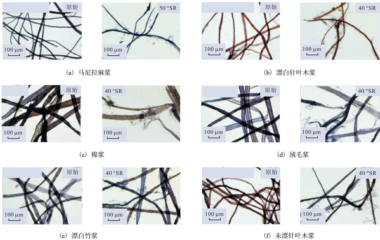
图 1 6种不同外加纤维打浆前后的扫描电子显微镜图
