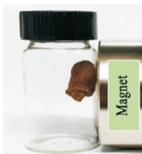
图 5 被永磁体吸引的 NCA/OA/ \text{Fe}_3\text{O}_4
