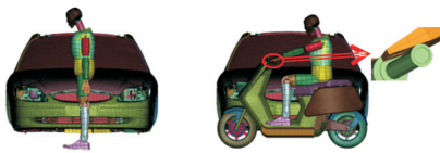
图6 行人与骑车人侧面碰撞仿真模型
