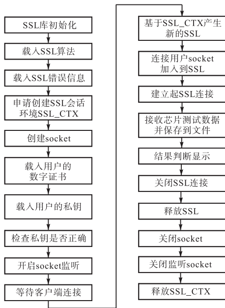
图 6 OpenSSL 服务器端加密设计 Fig. 6 OpenSSL server encryption design
