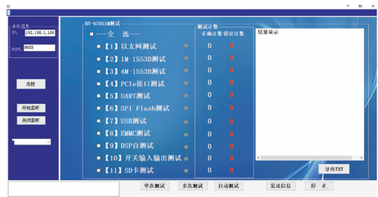
图 7 芯片测试平台界面 Fig. 7 Chip test platform interface
