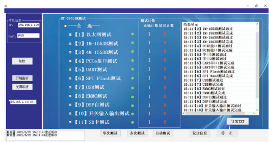
图 8 芯片测试平台单次测试结果 Fig. 8 Single test results of chip test platform
