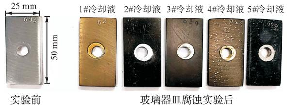
图 1 有机酸冷却液玻璃器皿腐蚀实验前后铸铝试片外观对比
