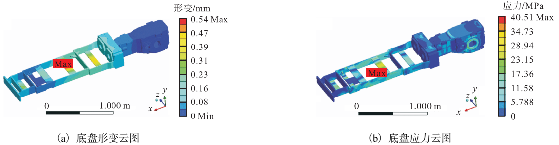
图 3 满载弯曲工况下底盘形变和应力云图
