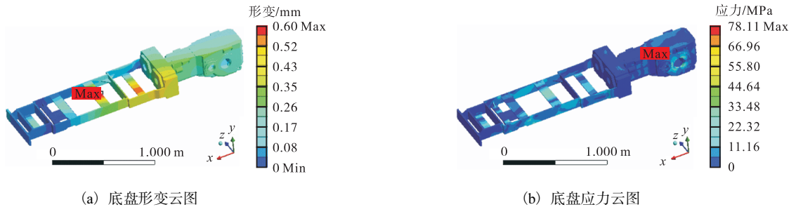
图 4 满载扭转工况下底盘形变和应力云图
