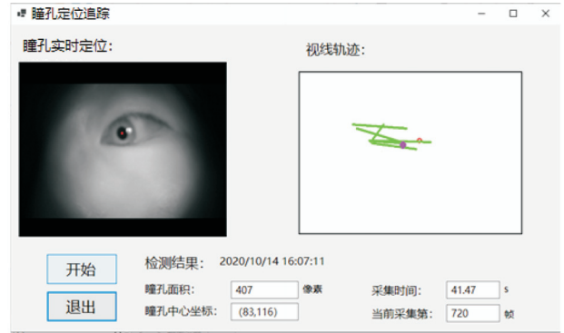
图 13 实时视线定位追踪软件界面 Fig. 13 Interface of real-time eye tracking software
