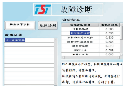
图 6 故障诊断人机界面
