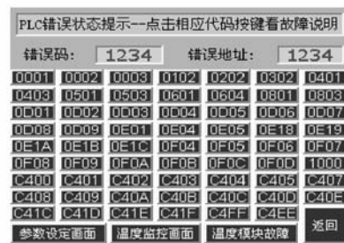
图 4 PLC 错误状态提示界面
