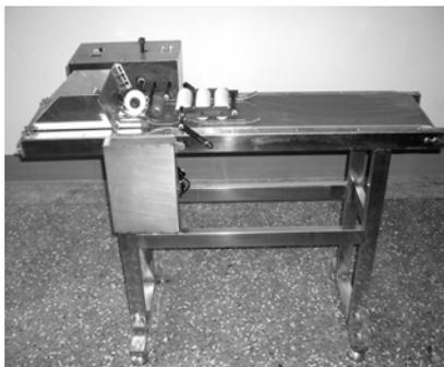
图1 高速激光打码分页机
