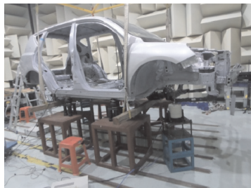
图6 白车身自由边界条件模态试验示意图
