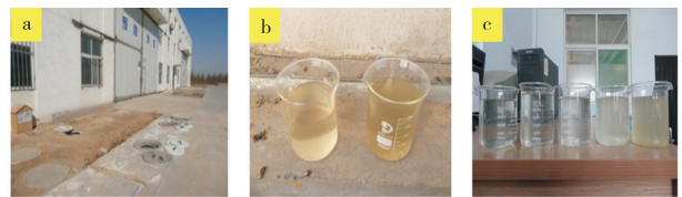
(a) 安装后的净化槽 (b) 2015-02-08 水样 (c) 2015-03-08 水样
