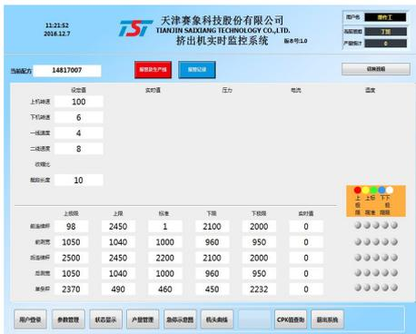
图 4 橡胶挤出机检测与控制系统主界面
