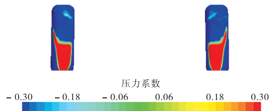
图3 前轮压力系数 Fig. 3 Pressure coefficient of front wheels
