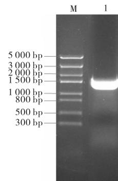
M. DL 5K marker; 1. *R. palustris* ATCC17001 编码 ALAS 基因的 PCR 产物
